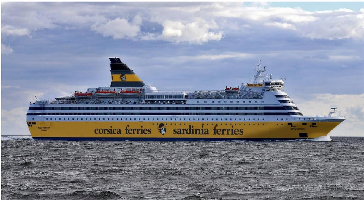
Avec ses 170 mètres de long, 28 mètres de large et 5 ponts accessibles, le Mega Victoria peut accueillir 2400 passagers et 450 véhicules et dispose de 900 mètres linéaires pour le roulage des marchandises.
